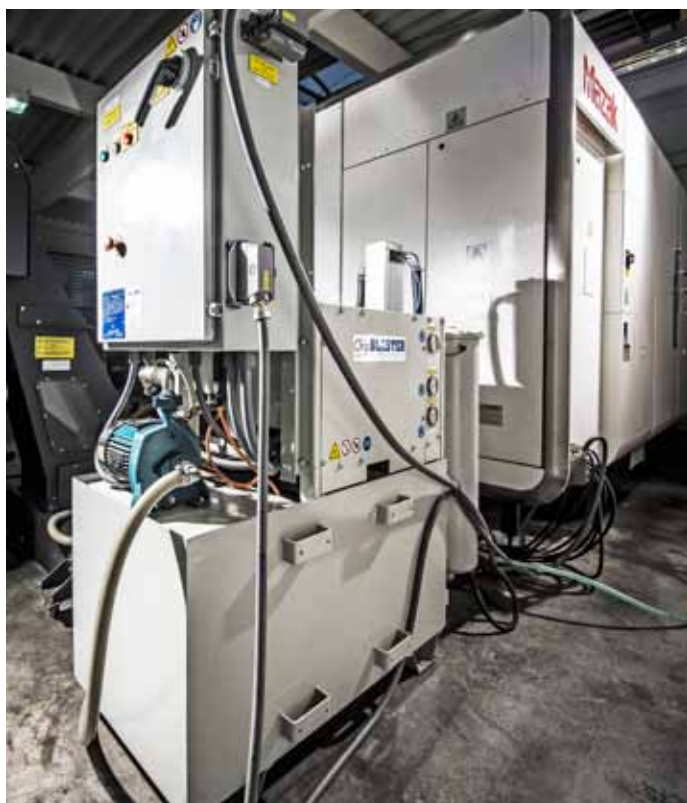
ChipBLASTER JV40 s automaticky regulovaným průtokem chladicí kapaliny
